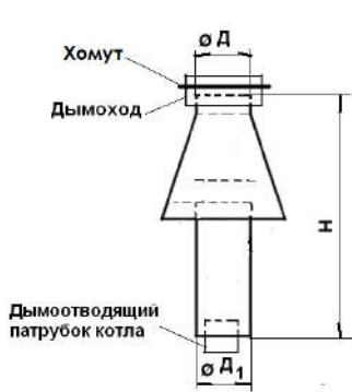
Схема подключения ООТЗ к котлу и дымоходу
