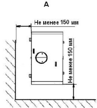
Схема установки котлов
