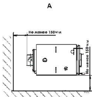
Схема установки котлов
